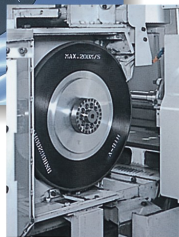
首創超高轉速每秒 200 公尺 (一分鐘12000米)可達極佳的加工面粗度
