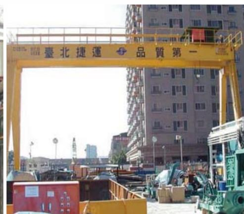
2005年台北捷運10噸門型吊車
