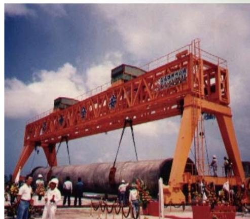
1988台北八里門型工程200噸門型吊車
