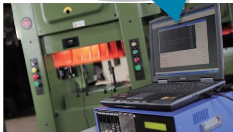
肘節式機構不同於一般曲軸式沖床，具有較長之下死點曲線，以提高模具壽命、降低衝擊噪音及提高產品精度效能。
