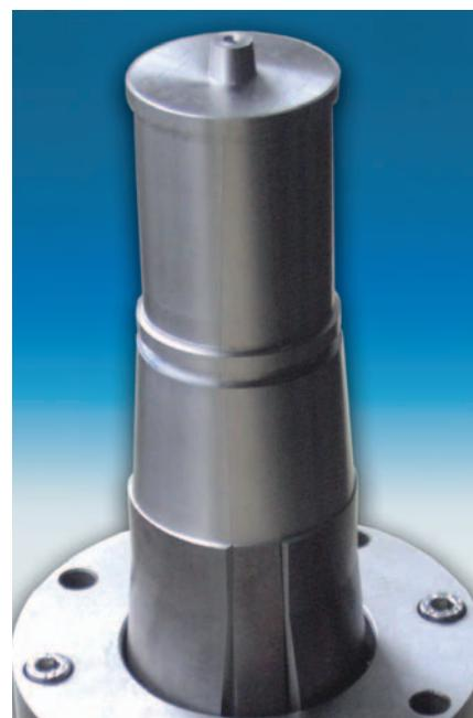
Der HASCO-Einfallkern Z 3600/. . .S wird vorzugsweise zum Entformen von Gewinden und innenliegenden Hinterschneidungen bei zylindrischen Teilen in Spritzgießwerkzeugen eingesetzt.
